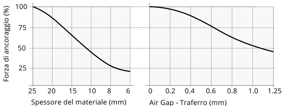
Il Polo Tipo 80 è progettato per sollevare lastre a partire da 8 mm di spessore con superficie piana. La forza nominale del Polo Tipo 80 è raggiunta con air gap di 0.4 mm. Con air gap 0, il Polo Tipo 80 raggiunge una forza di ancoraggio di 9 kN.
