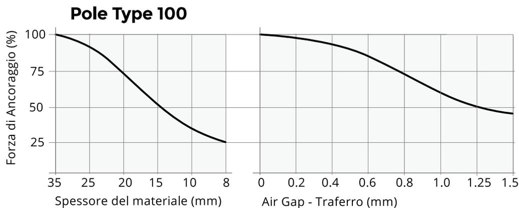
Il Polo Tipo 100 è progettato per sollevare lastre da 12 mm di spessore su superfici piane. Il valore nominale del FXE Polo Tipo 100 si raggiunge a partire da air gap di 0.6 mm. Con air gap 0, il Polo Tipo100 raggiunge una forza di ancoraggio di 14.5 kN.
